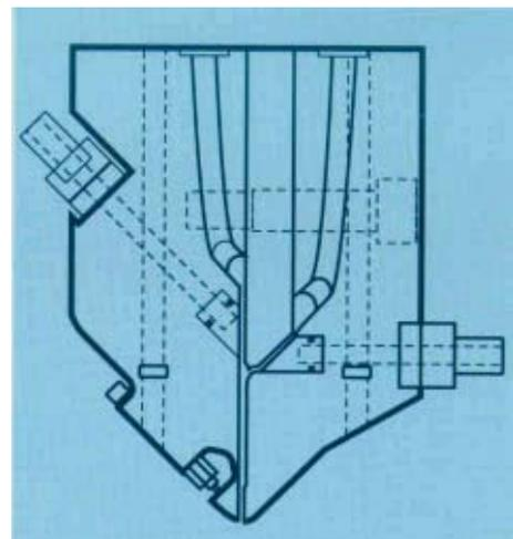
Figure 39. Multimanifold Die
