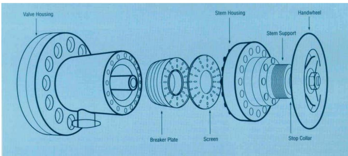
**Figure 28. Valve Assembly**
